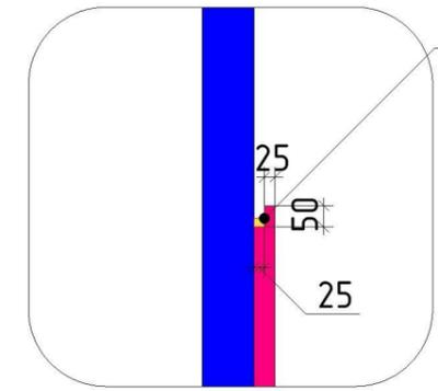
Накладной профиль со светодиодной лентой
